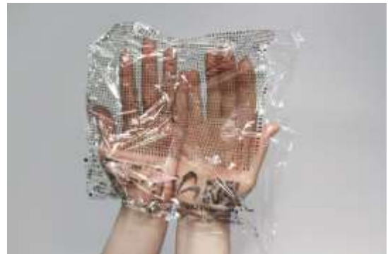
図 1 (b) 集積回路の外観写真 (サイズ: 200x200mm 2 )
